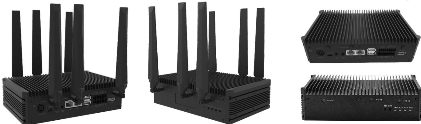
12VDC电源、OTG调试、音频输入输出、双网口、USB3.0、RS485、RS232口、DIDO、HDMI、4G/5G/GPS/Wi-Fi天线、SIM/TF
